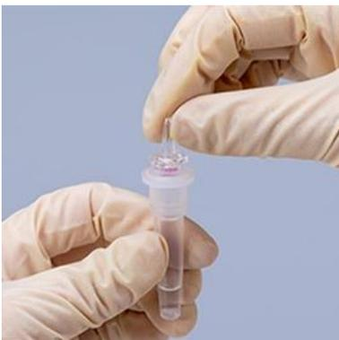
調製した試料液の入ったスクイズチューブに滴下チップをはめ込みます。
